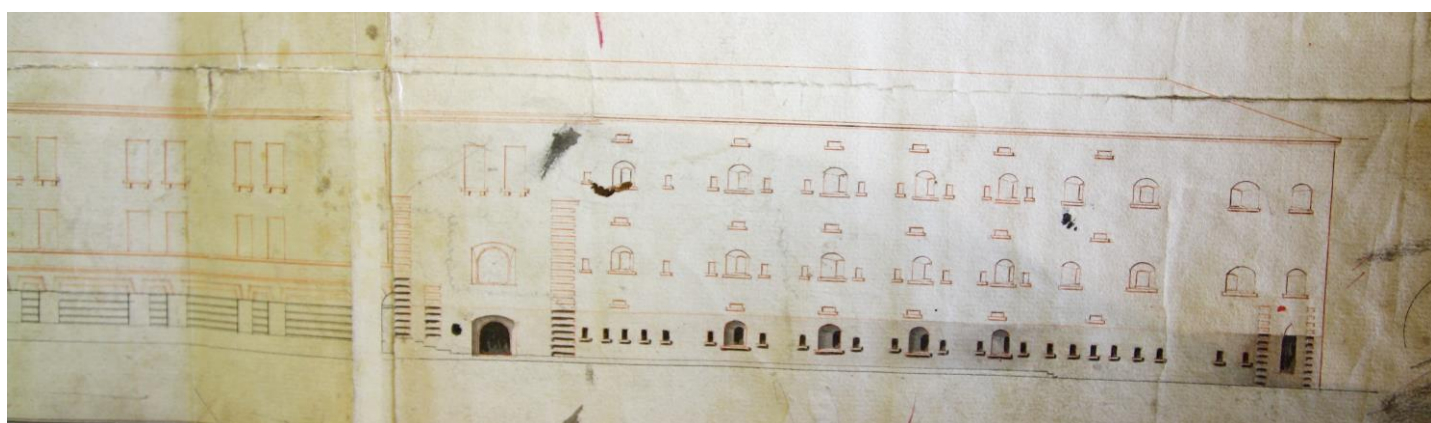
9.2. Goržihooone idatiiva maapoolne fassaad (punase joonega markeeritud ehitamata osad), valmis ehitatud esimese korruse vundament ja seinamüürid.
